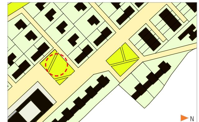
Die Straßenprofile werden in der Hauptachse „An der Güterhalle“ von 16 m auf 14,5 m zugunsten der Baufelder verkleinert. Die im Wettbewerb vorgeschlagen Gehwegsbreiten von 3,5 m auf der Ostseite und 2,5 m auf der Westseite der Hauptachse werden auf jeweils 2 m reduziert. Im Bereich der Güterhalle erfahren dadurch die Baufelder westlich der Hauptachse eine Vergrößerung. Nördlich der Güterhalle werden die Baufelder östlich der Hauptachse vergrößert.
