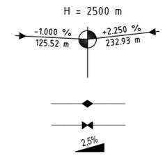
Neigungsbrechpunkt mit Angaben von Ausrundungshalbmesser, Längsneigung und Abstand zum nächsten Neigungsbrechpunkt
