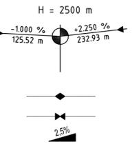
Neigungsbrechpunkt mit Angaben von Ausrundungshalbmesser, Längsneigung und Abstand zum nächsten Neigungsbrechpunkt
