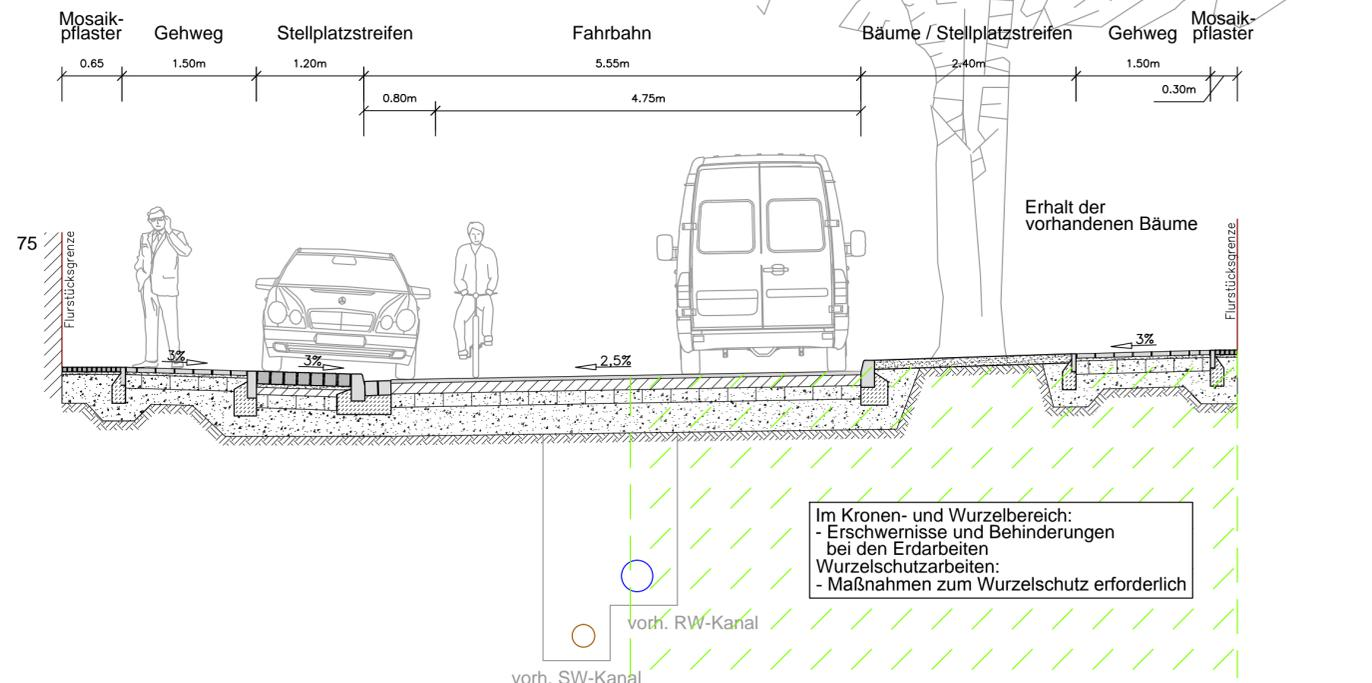
Aufbau der Fahrbahn in Asphaltbauweise: nach RStO 12, Tafel 1, Zeile 3 für Bk 1,8
