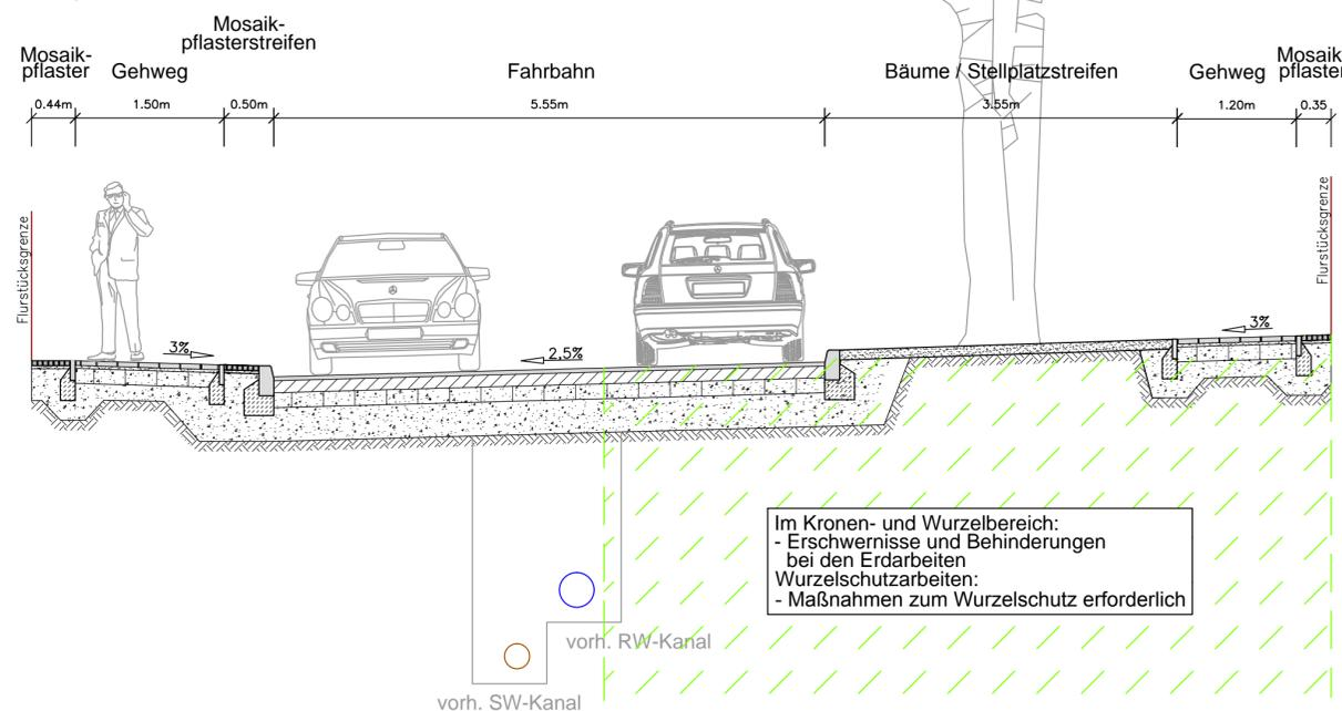
Aufbau der Fahrbahn in Asphaltbauweise: nach RStO 12, Tafel 1, Zeile 3 für Bk 1,8
