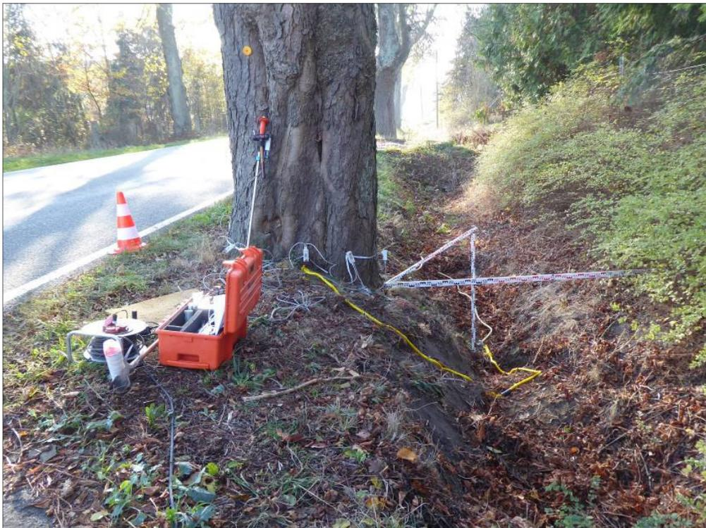
**Abb. 3: Alleebaum mit installierter Schalltomographie. Am Stamm bzw. an den Wurzelanläufen sind die Sensoren angebracht und miteinander verkettet, wobei ein Sensor mit dem Modul für die Wurzelortung verbunden ist.**
