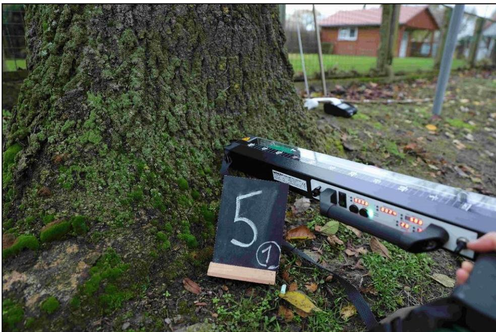
**Abb. 2:** Anwendungsbeispiel - Einsatz des Bohrwiderstandsmessgerätes (Resistograph) zur Prüfung der Qualität des Holzkörpers.
