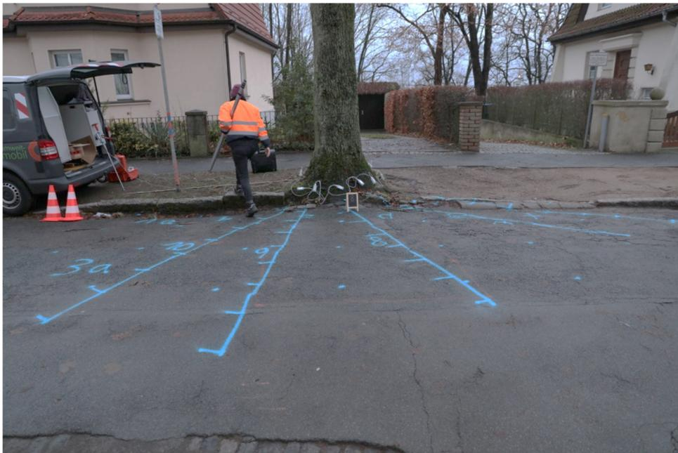
**Abb. 1:** Alleebaum mit installierter Schalltomographie. Am Stamm bzw. an den Wurzelanläufen sind die Sensoren angebracht und miteinander verkettet, wobei ein Sensor mit dem Modul für die Wurzelortung verbunden ist. Auf der Fahrbahn sind die Ortungslinien und Entfernungen zum Wurzelanlauf markiert.
