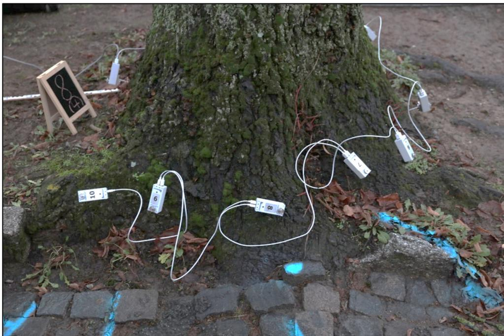
Kennzeichnung der Ortungsstrecken und Entfernungen sowie der Position der Sensoren für die Schall-Impuls-Tomographie am Stammfuß.
