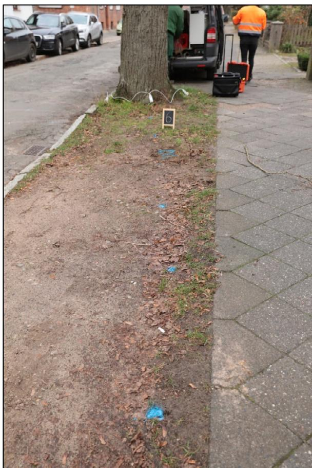
Kennzeichnung der Ortungsstrecken und Entfernungen sowie der Position der Sensoren für die Schall-Impuls-Tomographie am Stammfuß.
